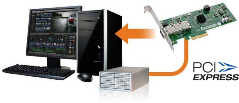
**B08S3-PS** 本体に同梱している専用PCIe-HBA (**Z2M-G3**) をワークステーションなど接続するホストにインストールし、**B08S3-PS** と直接接続します。
